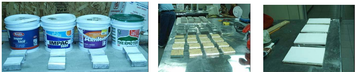
Figura 2. Recubrimientos elastoméricos reflectivos analizados
